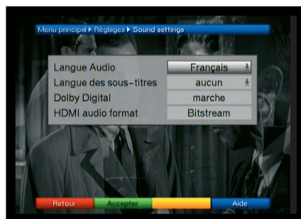
2 « REGLAGES AUDIO » permet de sélectionner sur la sortie HDMI, soit un flux PCM soit un flux « Bistream ».
